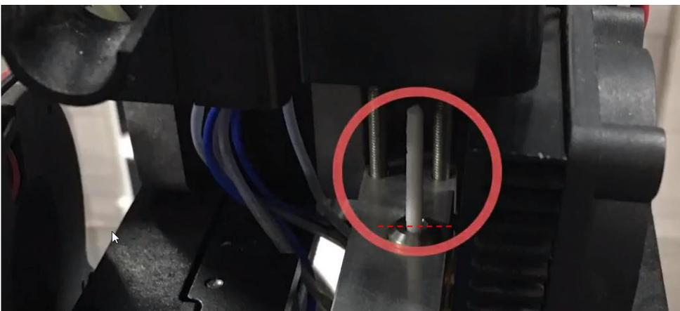
10. Démarrer le préchauffage de l'extrudeur bloqué et attendre la température de 230 degrés
